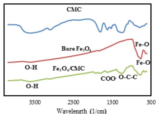
Figure 1. FTIR Spectra of CMC,  $\text{Fe}_3\text{O}_4$ ,  $\text{Fe}_3\text{O}_4/\text{CMC}$
